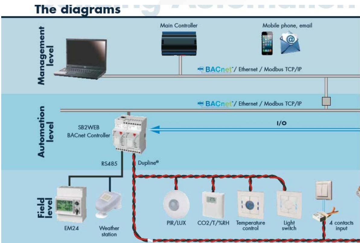
**Dupline** menghubungkan semua perangkat dalam BAS secara sederhana dan hemat biaya, serta memusatkan seluruh data di perangkat BACNet Controller SB2WEB. Setiap sistem atau aplikasi BMS (Building Management System) yang mendukung BACNet client, dapat mengakses seluruh data dalam **Dupline** melalui konektivitas BACNet/IP.
